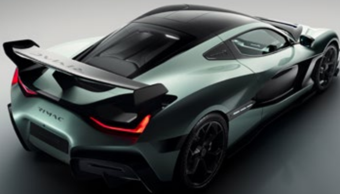
RIMAC NEVERA R DOTÉ D'UN PACKAGE AÉRODYNAMIQUE AGRESSIF COMPRENANT UN AILERON ARRIÈRE FIXE ET UN GRAND DIFFUSEUR.
