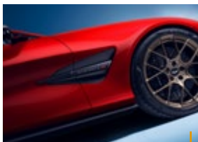
ENTRÉES D'AIR LATÉRALES DESTINÉES À REFRROIDIR LES FREINS DE LA VANQUISH.
